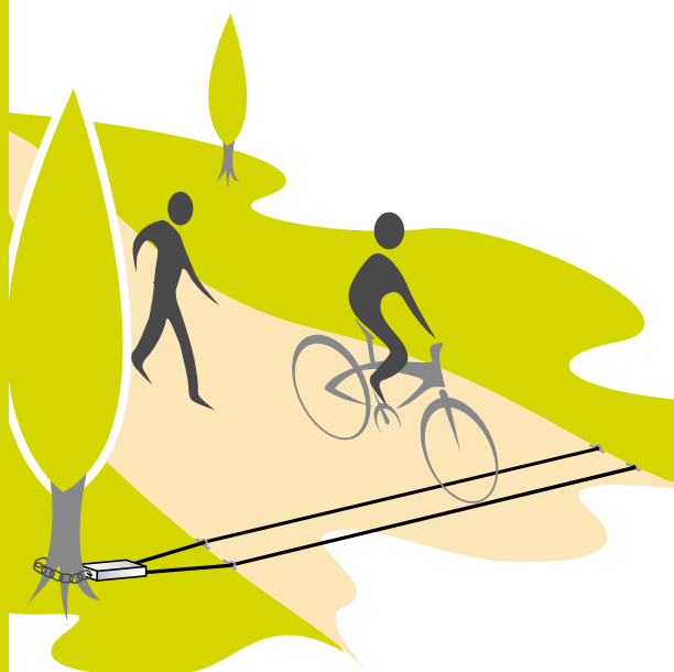
TUBOS neumáticos en una vía verde
