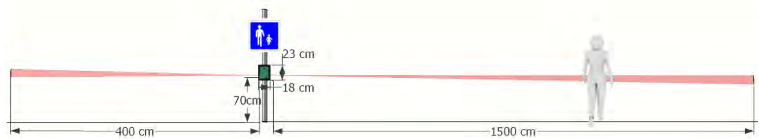
PyroBox con un sensor Pyro de medio alcance y un sensor Pyro Zoom, instalada en un poste en medio del paso
